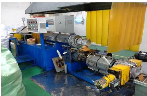
Công đoạn gia nhiệt tái chế nhựa
