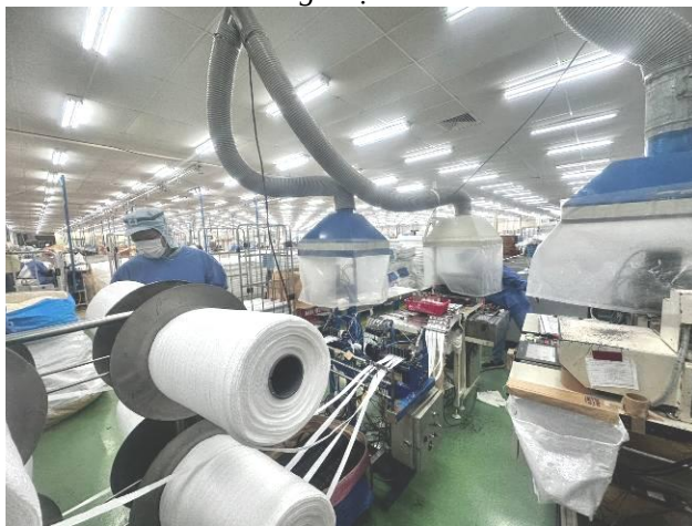
Công đoạn cắt dây đai, dây tape, dây thùng
