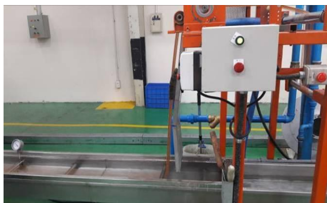
Máng nước giải nhiệt sợi nhựa sau khi gia nhiệt
