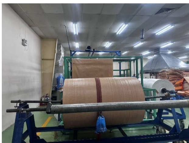
Vải cuộn gắn vào đầu máy cắt
