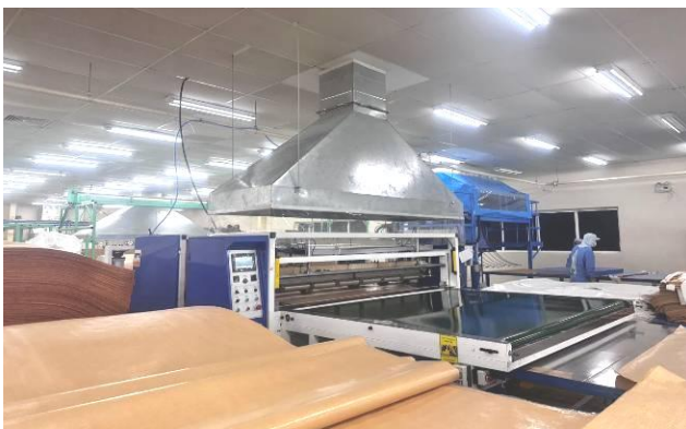
Vải cuộn gắn vào đầu máy cắt
